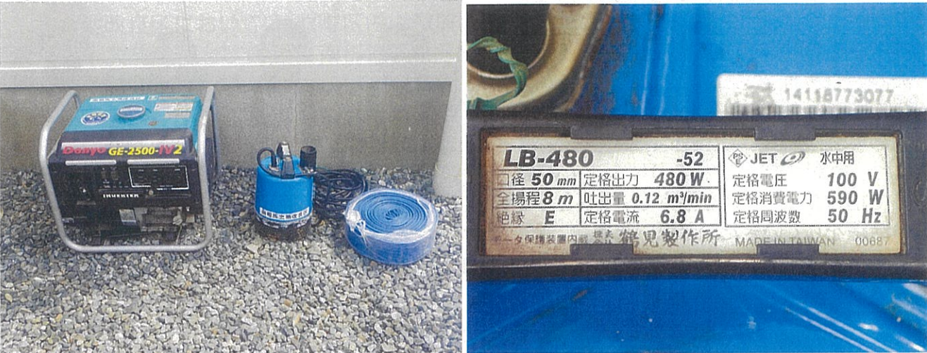
▲発電機・水中ポンプ・ホース
